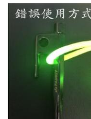
4 如何疏解營繩：由於發光提示營繩中有埋入 LED，因此可能發生過度扭曲情形，此時請務必讓營繩兩端向圈內疏解，不可向圈外猛拉，造成故障的發生。
