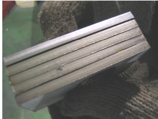
圖 5. 氮割厚板(良品與不良品)
