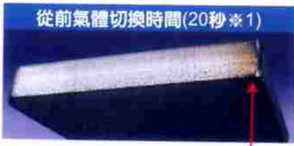
圖 8-a. 受到穿孔加工使用氧氣的影響,切斷時氮氣氣體純度的不足太低,導致切斷面發生變色
