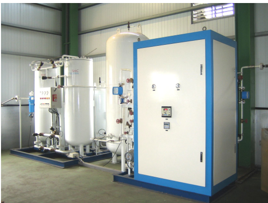
圖 15. 壹台雷射切割機量產中之氦氣機系統 (用戶) 氦氣機與精氦純化系統(氦氣純度達 99.9995%)
