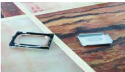
▲ 音圈、音膜與各種材質音膜黏接
